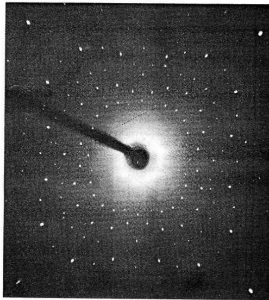
Fig. 17-37. Diagramme de diffraction de Laue d'un cristal de quartz. On a essayé de masquer l'effet du faisceau direct.
